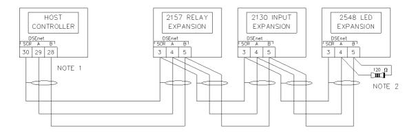
NOTE 1 AS A TERMINATING RESISTOR IS INTERNALLY FITTED TO THE HOST CONTROLLER, THE HOST CONTROLLER MUST BE THE FIRST UNIT ON THE DSEnet NOTE 2 A 120 DHM TERMINATION RESISTOR MUST BE FITTED TO THE LAST UNIT ON THE DSENET
